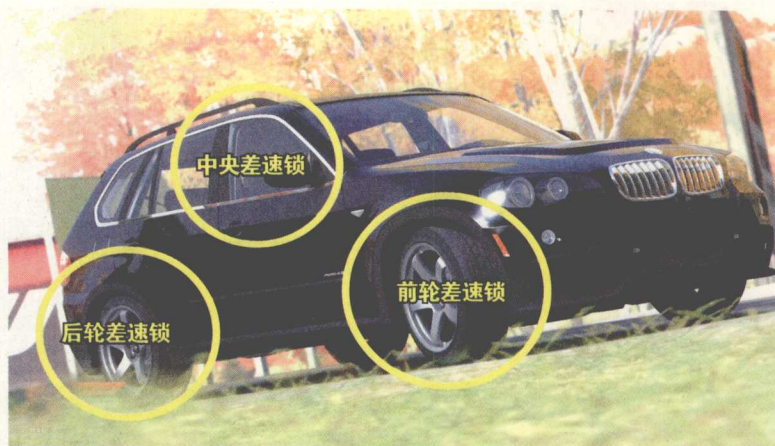
❷ 4驱越野车的差速锁通常分为前轮差速锁、后轮差速锁和中央差速锁
