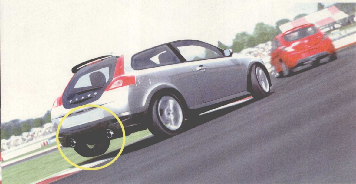
▲ 极限转弯造成的离心力甚至使内侧车轮轻微离开地面
