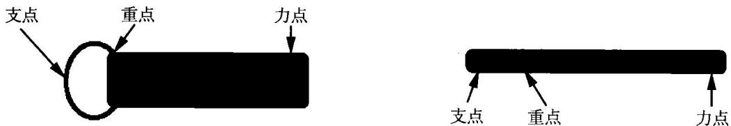
比较打开油漆桶的铁片和打开饮料瓶的开瓶器，会发现这两个杠杆的相同点是都有重点、力点和支点，都能节省力量。不同点是支点的位置不一样。在教学中可以让学生再找一找身边的物体，去发现还有哪些地方应用了杠杆。夹菜的筷子、夹细小物体的镊子、剪刀、钳子、钓鱼竿、跷跷板等。观察分析这些杠杆，提出和发现一些新的问题，会激发学生们的兴趣并为继续研究打下基础。
