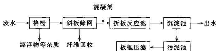
该工艺在进水 COD 为 1000~1200mg/L, SS 含量在 800~1200mg/L 的情况下，COD 的去除率  $\geq 60\%$ ，出水水质 COD 浓度小于 380mg/L, SS 小于 100mg/L，出水水质 COD 浓度略高于排放标准。该工艺的每吨废水处理费用为 0.31 元，其中药剂费 0.18 元，每日用电约 50kW·h，每度电按 0.55 元计，则每吨废水电费为 0.043 元，人工费（4 人）每吨废水 0.09 元。本方案工程总投资估算约为 28 万元。
