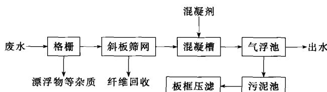
该工艺在进水 COD 为 1000~1200mg/L, SS 含量在 800~1200mg/L 的情况下，COD 的去除率  $\geq 65\%$ ，出水水质 COD 浓度小于 350mg/L, SS 小于 100mg/L，低于排放标准。该工艺的每吨废水处理费用为 0.36 元，其中药剂费 0.18 元，每日用电约 110kW·h，每度电按 0.55 元计，则每吨废水电费为 0.09 元，人工费（4 人）每吨废水 0.09 元。本方案工程总投资估算约为 30 万元。
