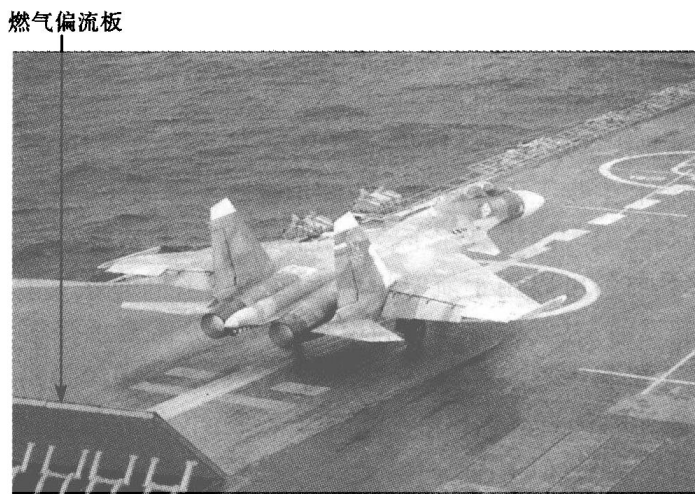
(b) 飞机起飞后燃气偏流板承受热载荷
