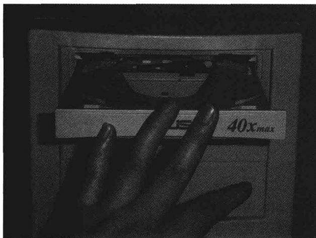
图 1.7 用手推回托盘会损坏光驱的传动齿轮
