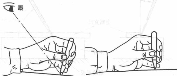
图 1-8 样冲的使用方法
