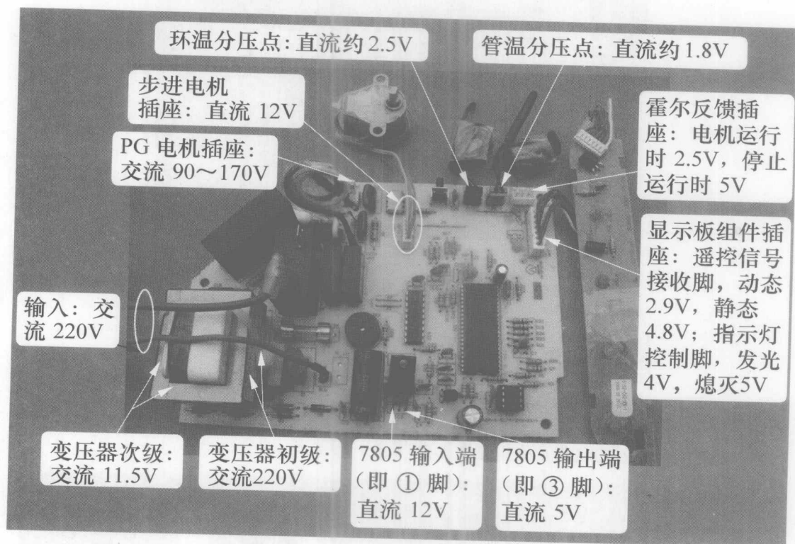
图 1-6 海信 KFR-23GW/56 主板关键点电压
