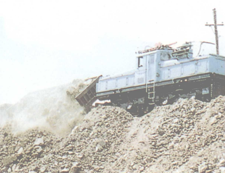
电力机车排岩
