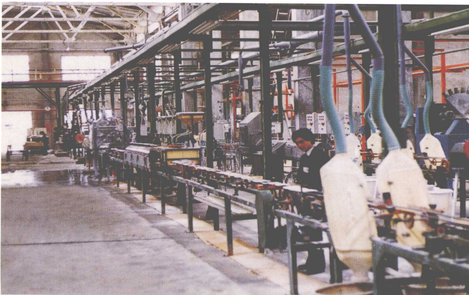
景德镇陶瓷厂 自动化淋釉生产线
