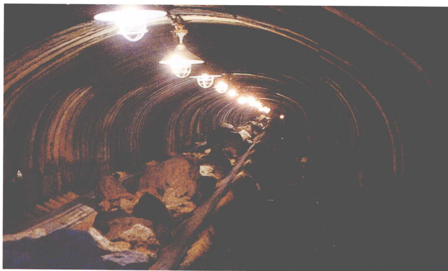
江西水泥厂全国水泥行业最大的矿山皮带运输机 (1.6 × 260 米)
