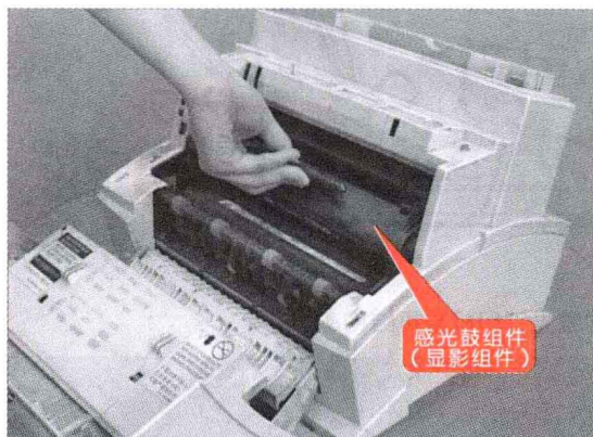
图 1-7 由上到下纸路的激光打印机的内部构成（型号：HP LaserJet6L激光打印机）
