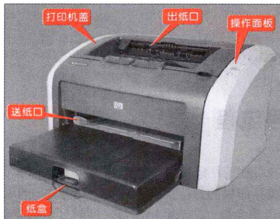
图 1-4 由下到上纸路的激光打印机的外部构成 (型号: HP LaserJet 1015 激光打印机)
