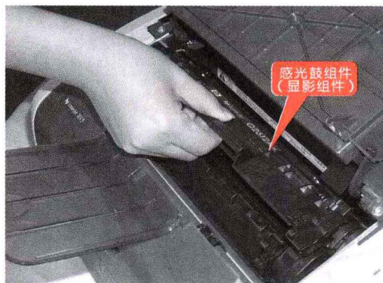
图 1-6 由下到上纸路的激光打印机的内部构成（型号：HP LaserJet 1015激光打印机）
