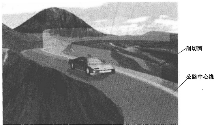
图 1-5 路线纵断面图的形成示意图
