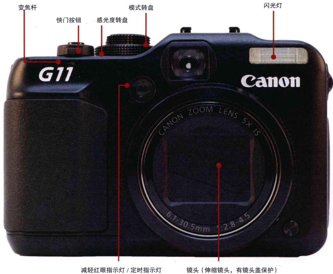
佳能 G10 和 G11 的机身几乎是一样的，所以以上使用了 G11 作为两者中的示范机型。两机之间最大的不同是 G11 配置了一个可旋转的显示屏，而 G10 的显示屏是固定在相机后面的。同时，G11 在模式键盘上采用了新的模式设置（请看下页的比较）。
