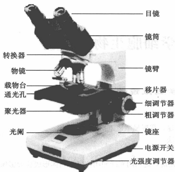
图 1-1 光学显微镜的构造
