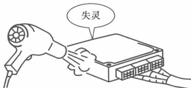
图 1-2 用加热法模拟故障
