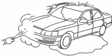
图 1-3 用水淋法模拟故障
