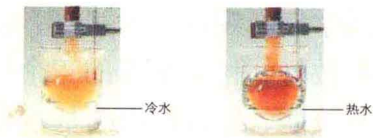
图2-2-8 装有 \text{NO}_2 和 \text{N}_2\text{O}_4 混合气体的烧瓶分别浸入冷水和热水中
