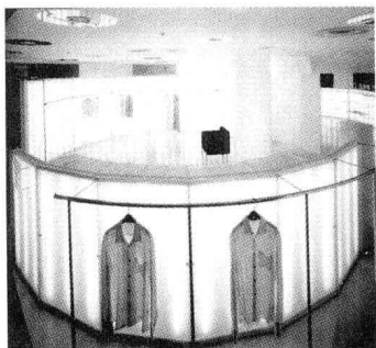
图2-9：用内置荧光灯管货架分割建筑空间，给原本多以平面构成的室内空间增添了一份灵动、流畅的视觉感受，透过乳白色树脂材料，光源显得柔和而浪漫。
