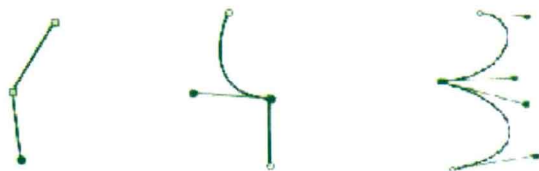
图2-4 角点的方向线
