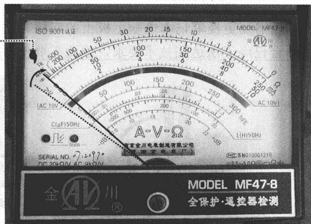
在测量元器件或电路的电阻值时，每调整一次挡位，就需对万用表进行0Ω校正，即将两表笔短接，表针指向最右侧，然后调整零欧姆校正钮，使指针指向 $0\Omega$ 。
