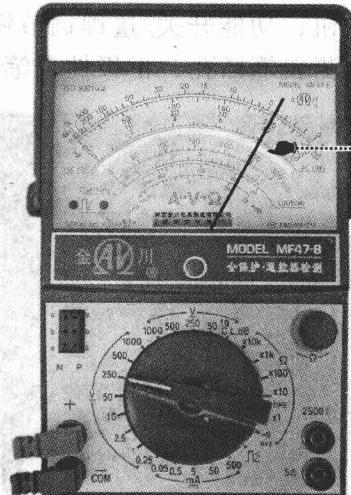
用万用表测量电阻值时，可将万用表的挡位调至电阻挡，然后用红表笔和黑表笔分别接在待测元器件引脚上，观察万用表的指针即可读出电阻值。
