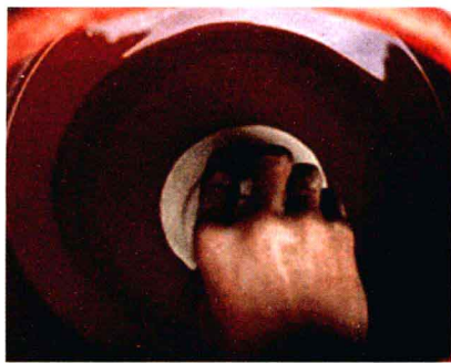
↑ 图1-41 浸釉法,将晾干的陶瓷坯体浸入釉浆中,使之表面挂满釉,然后取出
