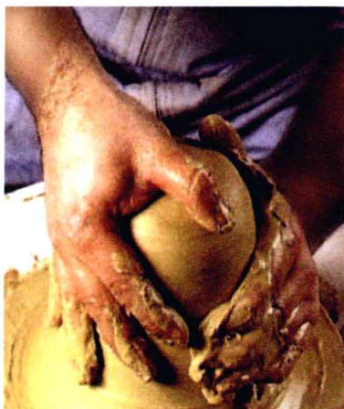
↑ 图1-31 左手中指与右手指相对，从底部向上缓慢提起，保持匀速，将坯体拉高
