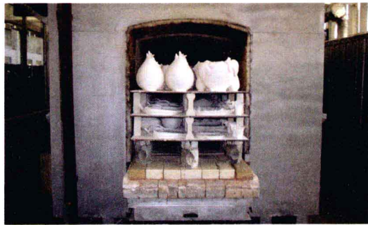
↑ 图1-44 将入窑烧制的半成品瓷器
