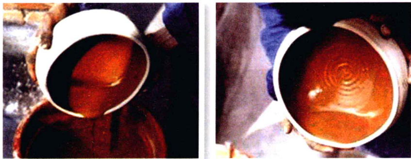
↑ 图1-42 荡釉法,把部分釉浆倒入坯体中,然后将坯体上下左右旋荡,使陶瓷器的内部均匀地罩上一层釉浆,再将多余的釉浆倒出
