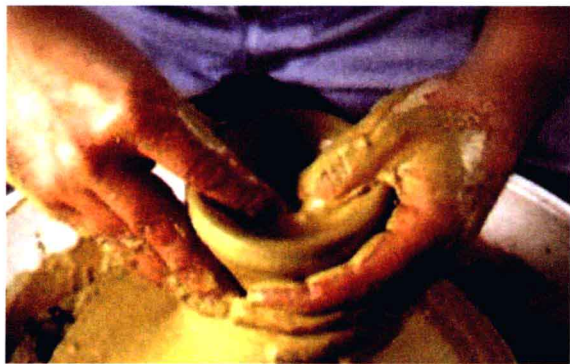
↑ 图1-33 用力均匀，保持坯体厚薄，口缘平整，然后用手指除去多余的黏土
