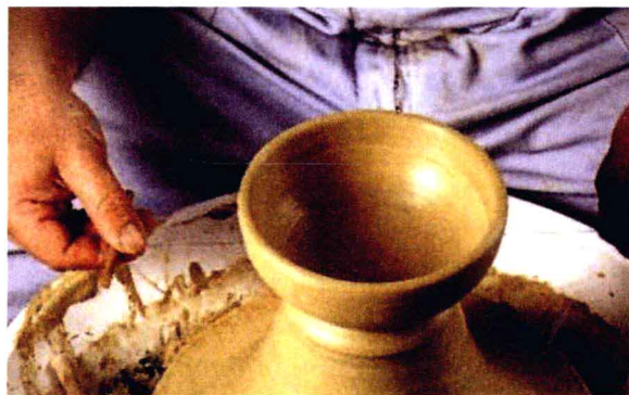
↑ 图1-34 拉坯机减速，用丝线缠到物体底部，切入泥中，将坯切下来
