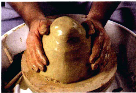
↑ 图1-30 将揉好的泥放在拉坯机转盘中心,并打开电源
