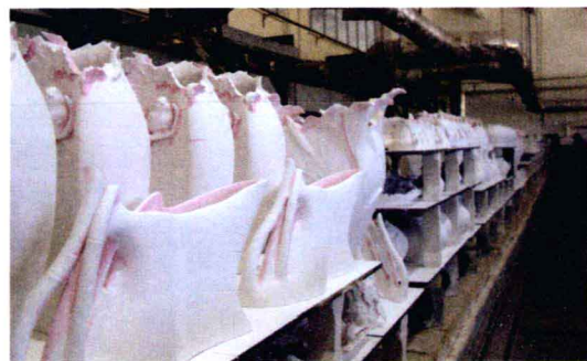
↑ 图1-45 经过高温烧制的瓷器成品出窑
