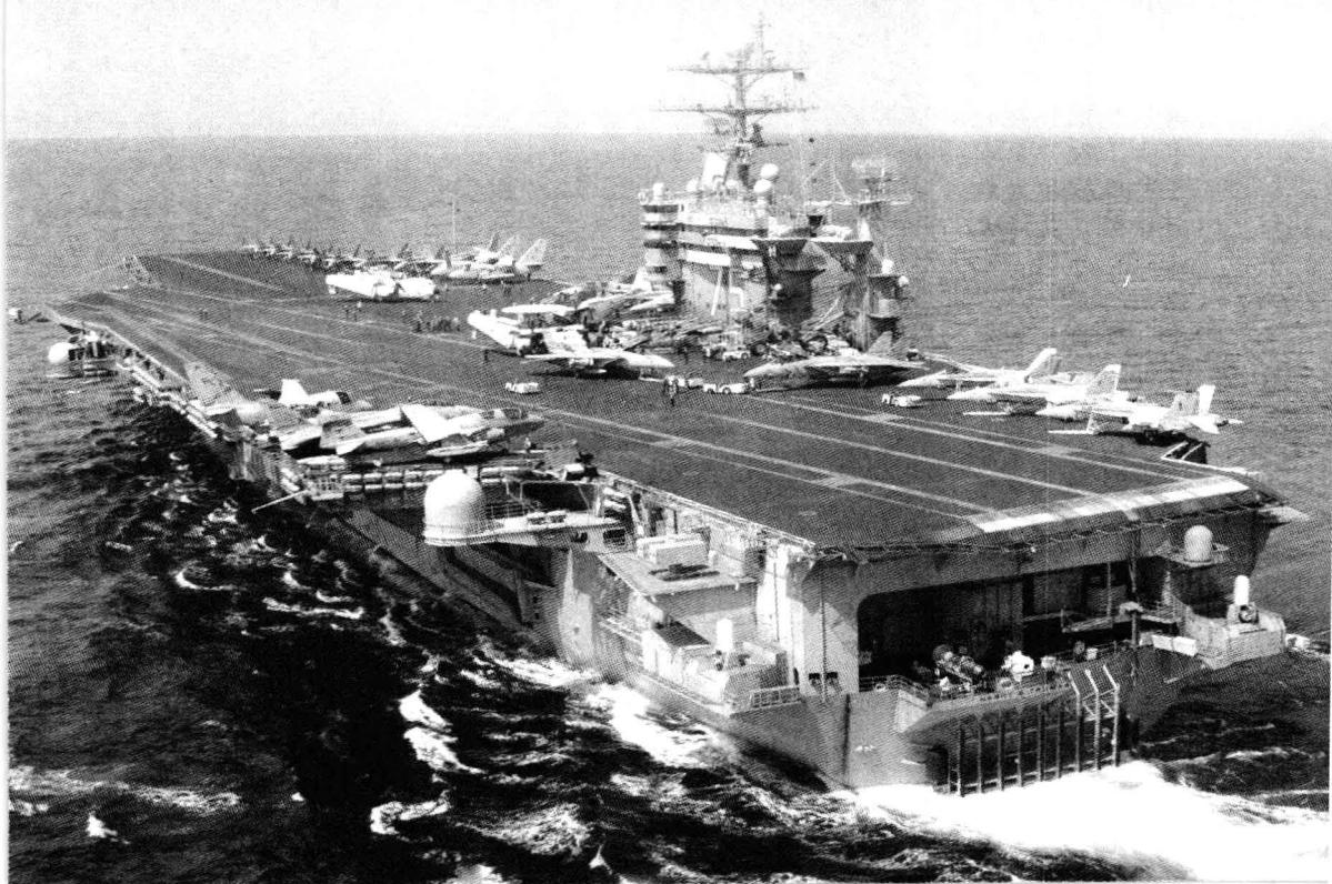
母舰能够通过舰艏的弹射器起飞飞机的同时，可以在斜角飞行甲板上降落飞机。
