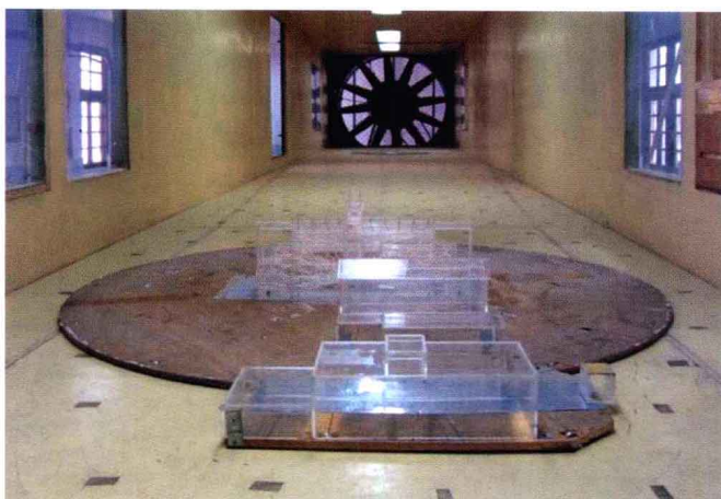
图 2-3 建筑模型风洞实验实景
