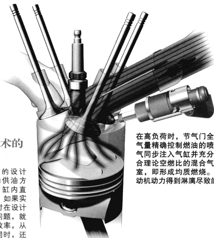
FSI原理示意图（节气门全开状态）
