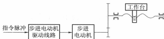
图 1-3 开环控制数控机床的系统框图
