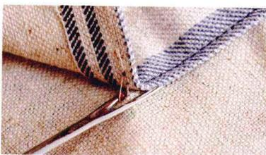
注意拆线刀方向，换成红球端在内侧，即可滑顺地快速往前划开。
