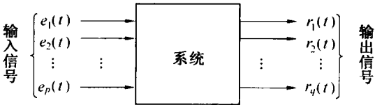
图 1.1.4 具有 p 个输入和 q 个输出的系统
