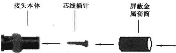
图 1.2.8 BNC 头的构成
