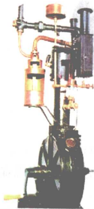
图1-7 戴姆勒制造的立式汽油发动机
