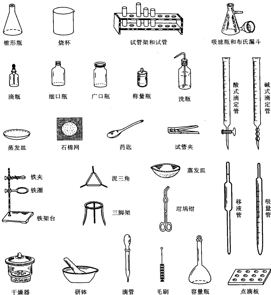
图 2-2-1 部分无机化学实验常见仪器及器具
