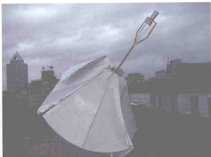
阳江市气象局卫星天线被损坏。
