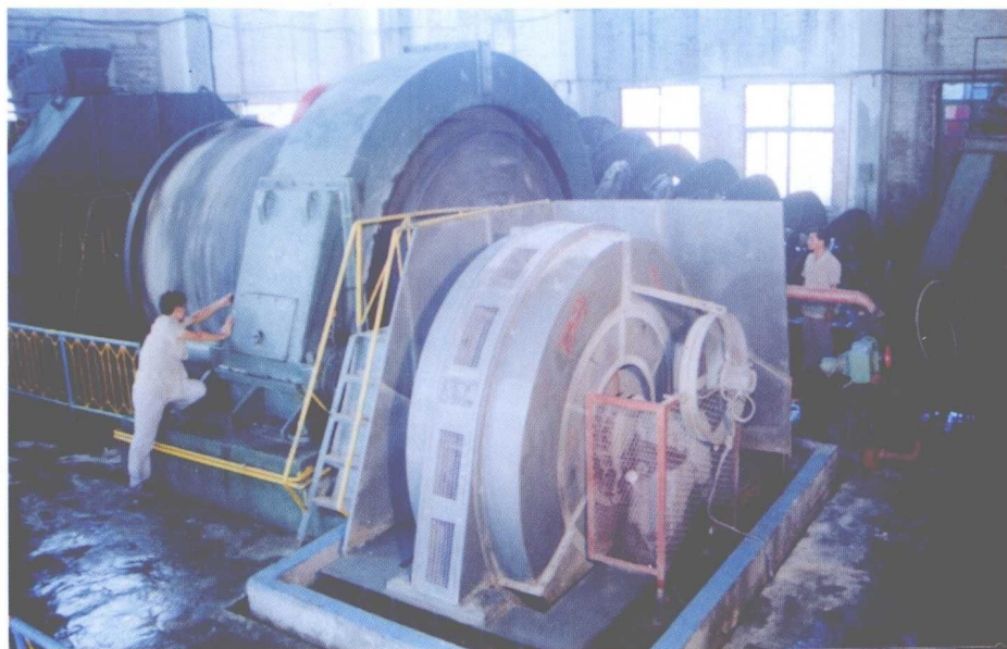
全国黄金矿山最大的球磨机——莱州金仓矿业有限公司仓上金矿选矿厂球磨机
