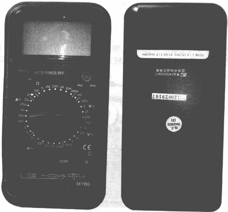
图1-2 MY60型数字万用表的正、反面实物图
