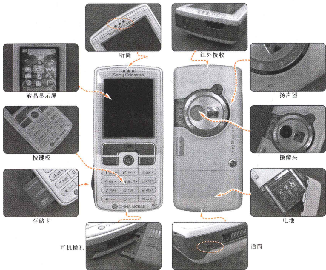
(a) 直板式手机外形结构特点
