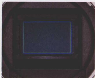
反光镜后面的感光元件
