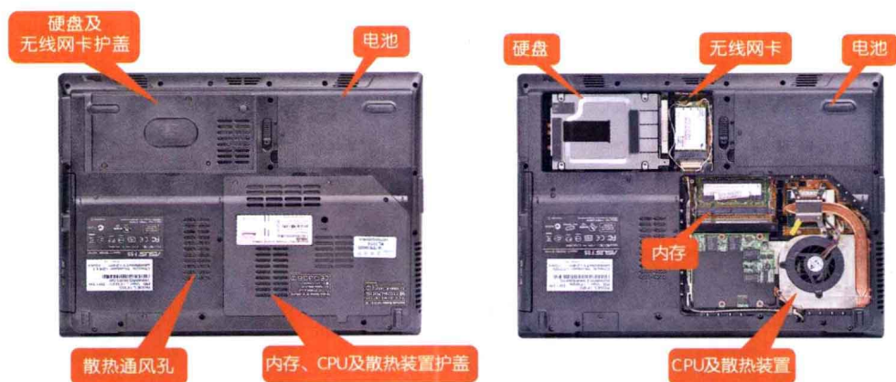
图1-3 笔记本电脑整体外部结构（底部）
