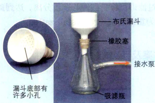
图 1-1-4 抽滤装置
