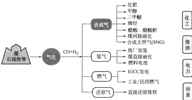
煤气化的过程实质是将难以加工处理、难以脱除无用组分的固体煤，转化为易于净化、易于应用的气体的过程，简言之，是将煤中的 C、H 转化为清洁燃料气或合成气 ( $\text{CO} + \text{H}_2$ ) 的过程。与煤的直接燃烧相比，气化是对煤中所蕴含的化学能的梯级利用，或者说直接燃烧以热量利用为主，产生的污染物比较多，而气化以生产合成气 ( $\text{CO} + \text{H}_2$ ) 为主，可充分利用煤中的有效 C、H 元素，产生的污染物比较容易脱除，例如可通过后续成熟技术将硫转化为产品硫黄。
