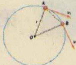
图 2-9 当 B 点无限接近 A 点时, AB 之间的平均速度就是 A 点的瞬时速度
