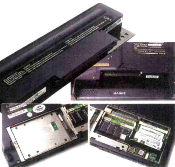
图2 电池、电池槽、硬盘、内存和无线网卡
