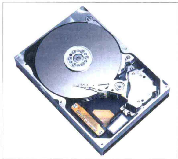
图 15 笔记本硬盘内部构造
