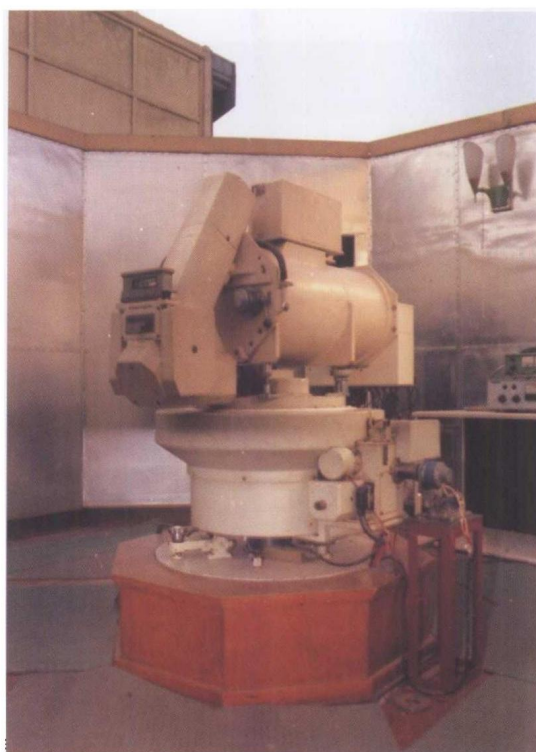
中国研制的性能领先世界的沙河站 II 型光电等高仪（1975 年—）
