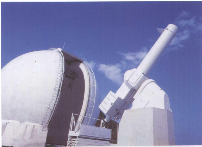
由中国首次提出并研制成功的能进行磁场和速度场视频测量的 怀柔太阳磁场望远镜(1986年一)
