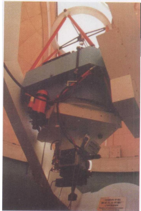
兴隆站 1.26 米红外望远镜 (1991 年—) 是我国自行研制的首台米级红外望远镜
