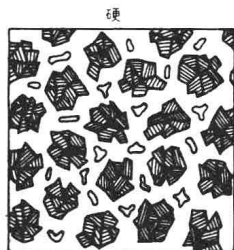
▲結合劑量較少氣孔多即成較軟的砂輪，結合劑量較多即成較硬的砂輪
