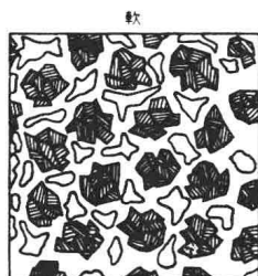
▲結合劑量較少氣孔多即成較軟的砂輪，結合劑量較多即成較硬的砂輪
