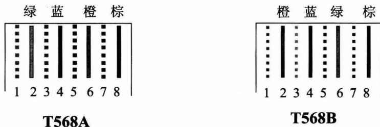
图 1-2-2 双绞线 T568A 与 T568B 线序示意图
