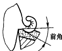
图 1-16 车刀前角的变化
