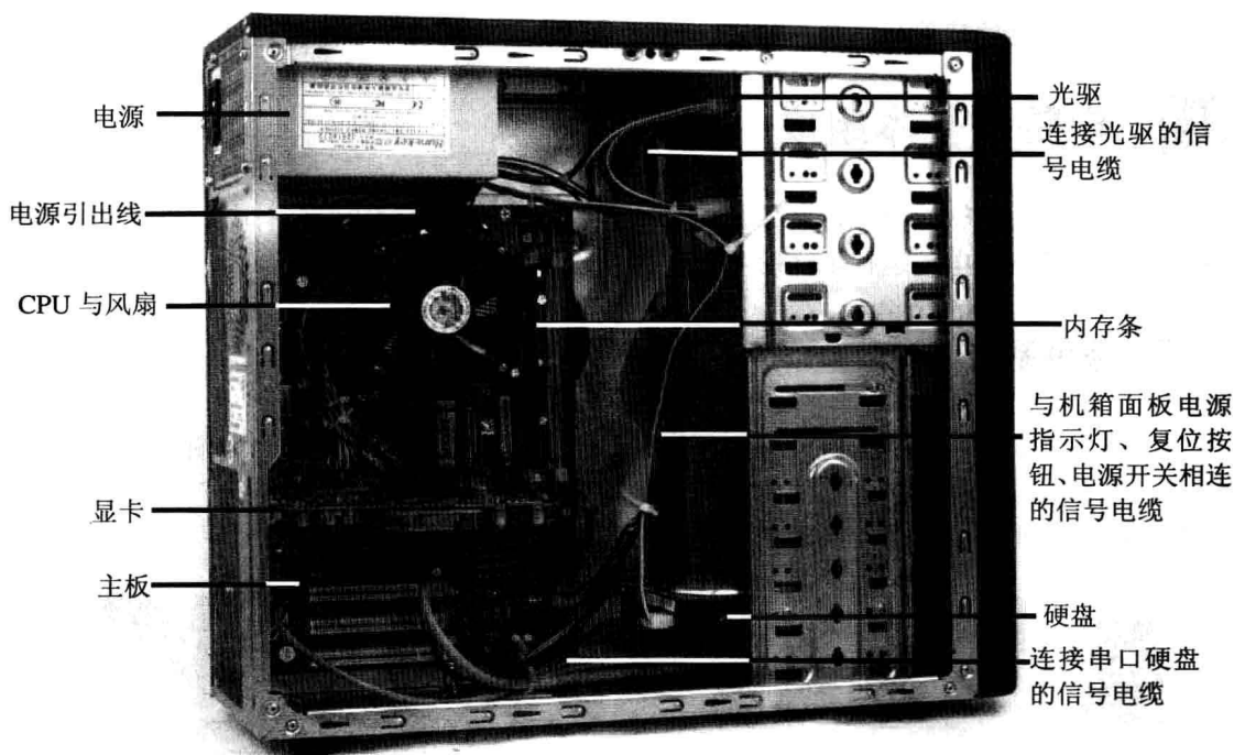
图 1-4 机箱内部的配件
