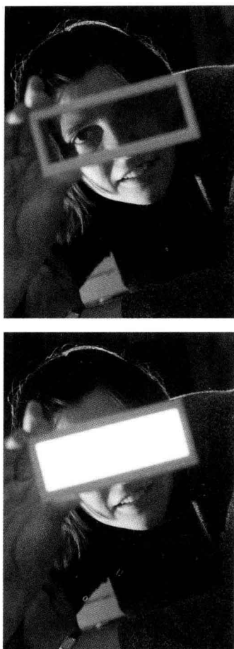
图 1-23、24: LED 技术的推广: 通过调节 LED 灯的亮度来控制玻璃的透明度。
