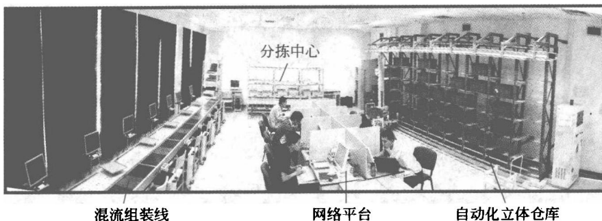
图 1-2 物流实验室的整体布局示意图
