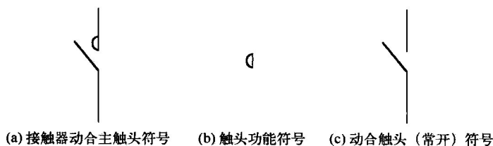
图 1.1.1 接触器动合主触头符号组成
