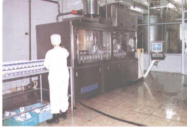
↑ 三元食品有限公司的屋型奶灌装流水线。
