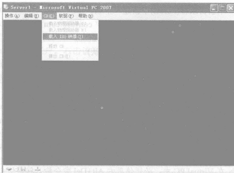
图 5 将一个 ISO 文件与一台虚拟机进行关联
