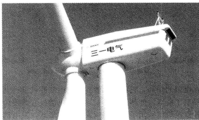
图 1-2 三一电气 SE7715 双馈风力发电机组
