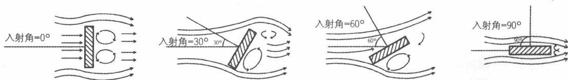
图 2-3 风向入射角对建筑气流的影响
